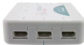
Drei analoge Sensoranschlüsse – zum Anschluss von über 50 kompatiblen Sensoren wie Temperaturfühlern, pH- oder Gasdrucksensoren
