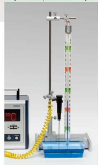
Aufbaubeispiel analoge und digitale Temperaturmessung
